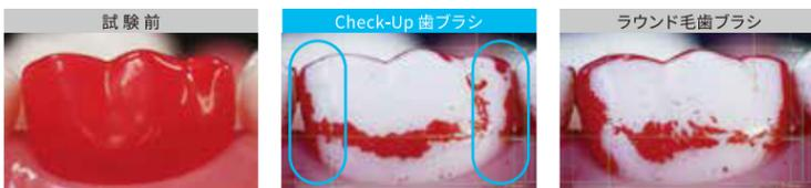
顎模型下顎左第一大臼歯にモデル歯垢を塗布し、刷掃後の歯垢が除去された比率を画像解析で算出。荷重:200g 刷掃回数:10回 ※Slimhead II 33Mを100とした場合の指数
